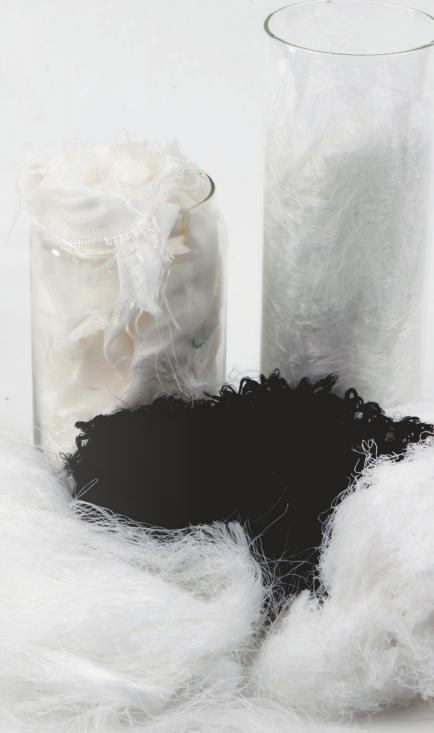
利用廠內紡絲、織布時產生的廢紗廢布與其餘下腳料，分類後經過粉碎、熔融、重新聚合並造粒等過程，將原先的廢棄材料再生成有價值的紡絲原料。透過物理回收製程，回收聚酯纖維不僅具有如同一般聚酯的優良品質，更能有效減少能源損耗及降低二氧化碳排放量，達到延續產品生命力的目標。
